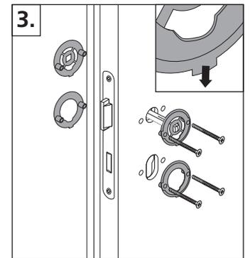
4. Kunststoff-Führungen an den Sollbruchstellen ausbrechen und entfernen.
