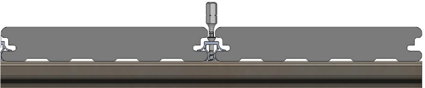
**Schritt 1:** Lockern Sie den Clip etwas und verschieben Sie ihn, bis sich der Schraubenkopf über dem „Schlüsseloch“ befindet.
