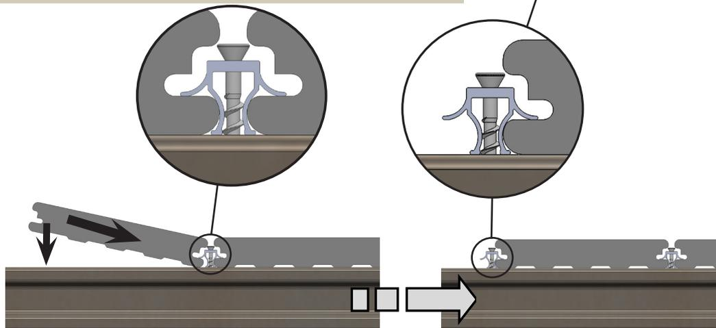
**Schritt 3:** Schrauben Sie die erste Reihe Clips komplett fest.
