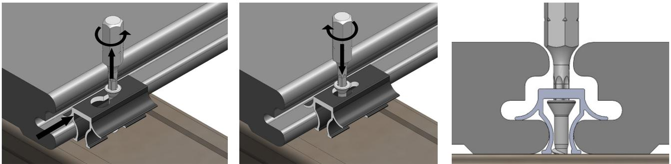
**Schritt 3:** Verschieben Sie den Clip bis zum Dielenende, um ihn zu entnehmen.
