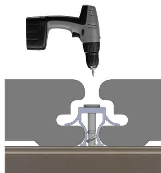
**Schritt 4:** Nachdem Sie die nächste Diele eingesetzt und mithilfe eines Standard-Distanz-Clips befestigt haben, schrauben Sie die zweite Reihe Clips komplett fest. Wiederholen Sie diese Schritte für jede Dielenreihe, die abnehmbar sein soll.
