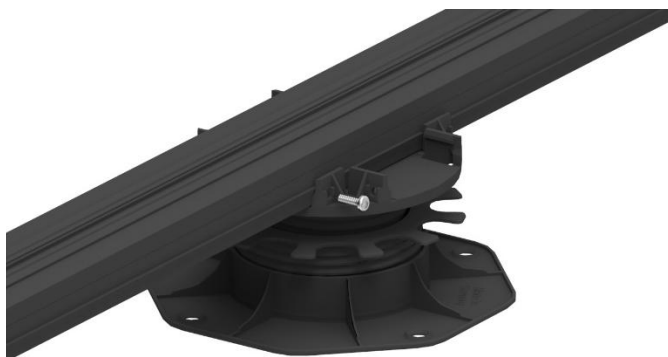
Bild 7. Die Aluminiumunterkonstruktion wird auf das Terrassenlager so weit aufgedrückt, bis das Terrassenlager eingerastet ist. Danach sollten alle Terrassenlager mit je 1 Bohrschraube 3,9 x 25 an der Unterkonstruktion fixiert werden.
