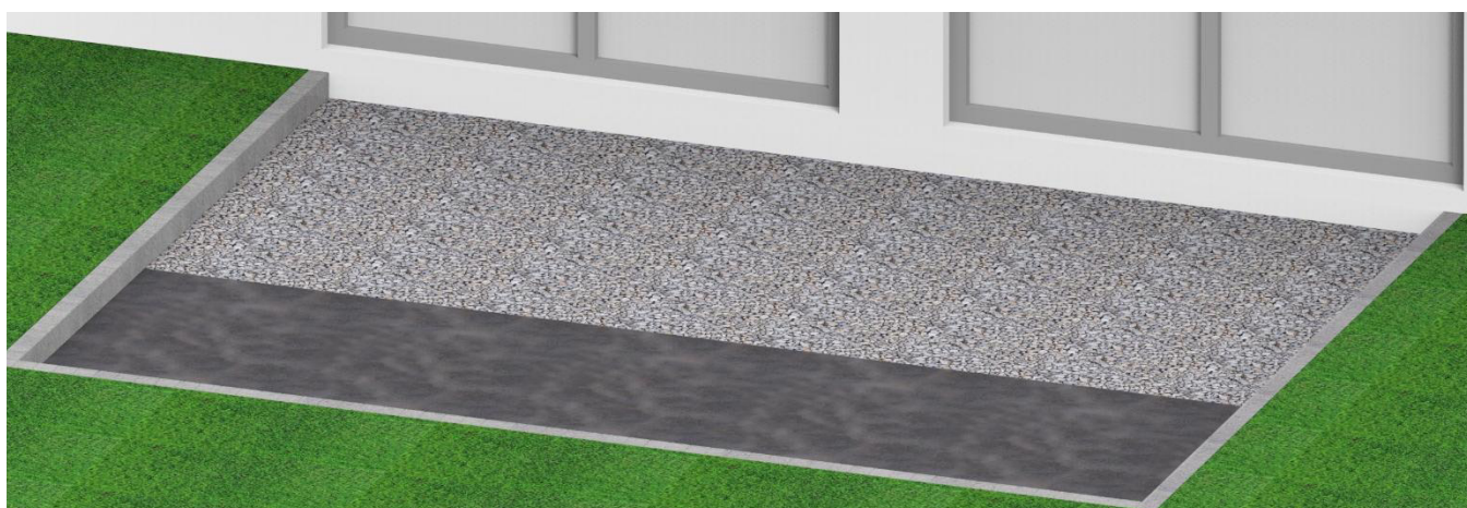
Bild 2. optional kann auf die Bettungsschicht ein wasserdurchlässiges Unkrautvlies verlegt werden. Die Bahnen sollten ca. 10 cm überlappen.
