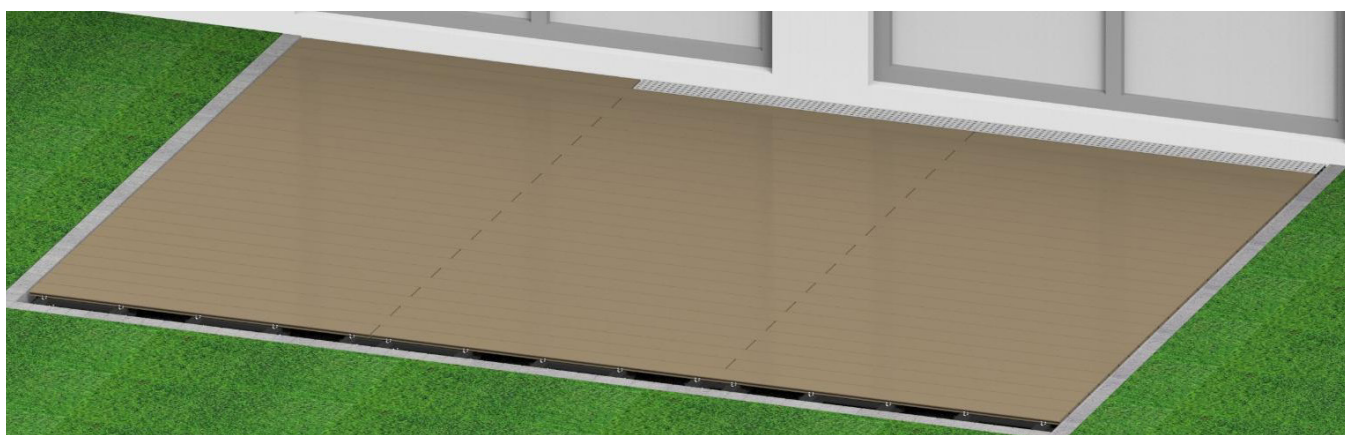
Bild 30. Achten Sie darauf, dass die letzte Diele möglichst gleich breit ist und nicht schmaler geschnitten werden muss.
