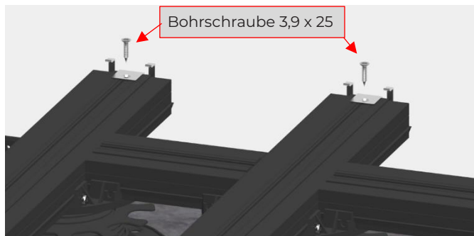
Bild 22. Die Rand-Clips bei der WPC-Diele werden mit 20 mm Abstand zur Hauswand und die Rand-Clips für das Rainageprofil mit 8 mm Abstand montiert.
