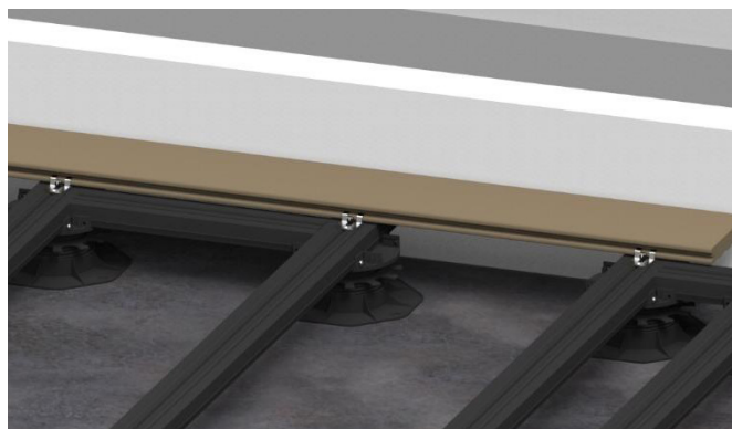
Bild 14. Die kürzesten WPC-Terrassendielen müssen immer auf mindestens 3 Unterkonstruktionen aufliegen.
