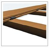
2. Installieren Sie nun Terrassendiele für Terrassendiele mittels WPC Befestigungsclips seitlich in den Nuten und den Clip auf der Unterkonstruktion mit einer Schraube. Auch hier das Vorbohren nicht vergessen. Wiederholen Sie diesen Vorgang bis Sie zur letzten Terrassendiele gelangen.
