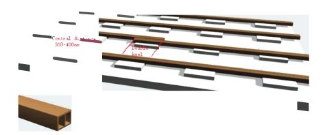
Wir empfehlen dringend die Unterkonstruktion mit dem Untergrund mittels Spezialdübel und Spezialschrauben siehe Skizze zu befestigen. Bei Verwendung von Terrassenlagern auch diese mit der Unterkonstruktion, sowie auf dem Untergrund befestigen.
