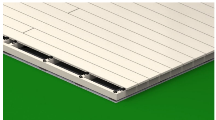
Bild 32. Die vorderste Terrassendiele sollte wenn möglich ca. 10 mm über die vordere Unterkonstruktion überstehen. Die Befestigung ist nicht mit dem RASK-Clip möglich, sondern sollte mit Terrassenschrauben und Teilstücken vom RASK-Clip erfolgen. Sie können diese Unterlegstücke einfach vom RASK-Clip abbrechen.
