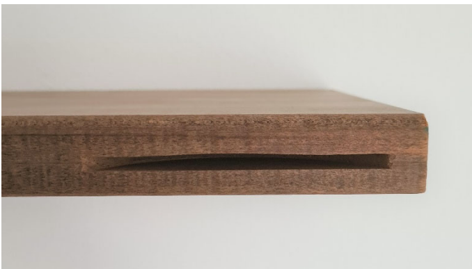
Bild 41. Die Lamello Einfräsung muss ca. 9 mm tief sein und ca. 8,5 mm von Unterseite der Diele liegen.
