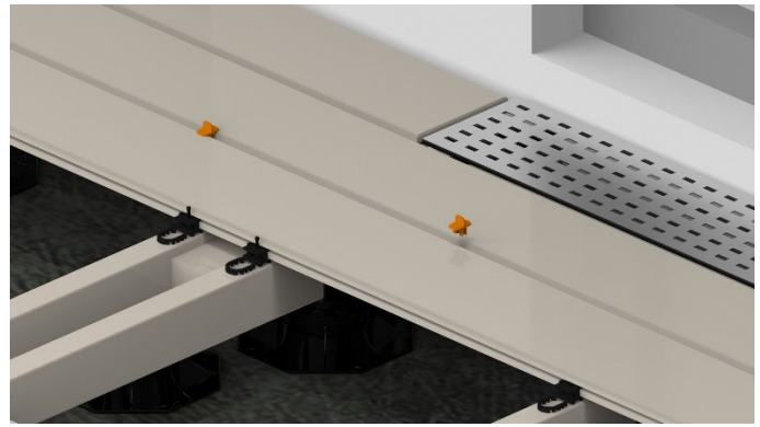
Bild 28. Damit immer ein Fugenabstand von 8 mm zwischen den Dielen eingehalten wird, nutzen Sie die beiliegenden Abstandshalter. In jedem Paket RASK-Clips sind 2 Abstandshalter enthalten. Bei längeren Terrassendielen sollten 3 oder 4 Abstandshalter verwendet werden.
