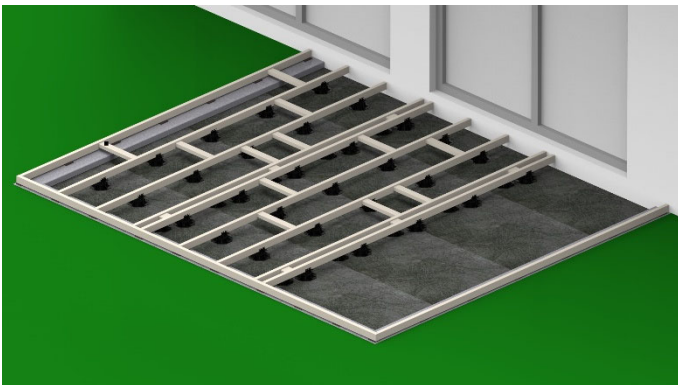
Bild 12. Montieren Sie alle weiteren Unterkonstruktionsbalken inkl. der benötigten Verstellfüße als ausgesteifte Rahmenkonstruktion.
