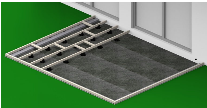
Bild 8. Mit kurzen Querhölzern wird eine ausgesteifte Rahmenkonstruktion erstellt.
