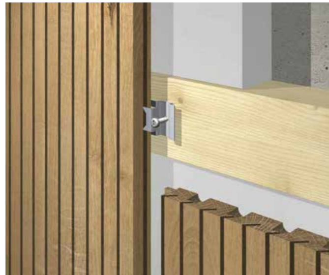
Detailansicht: vertikale Montage mit Montageclip
