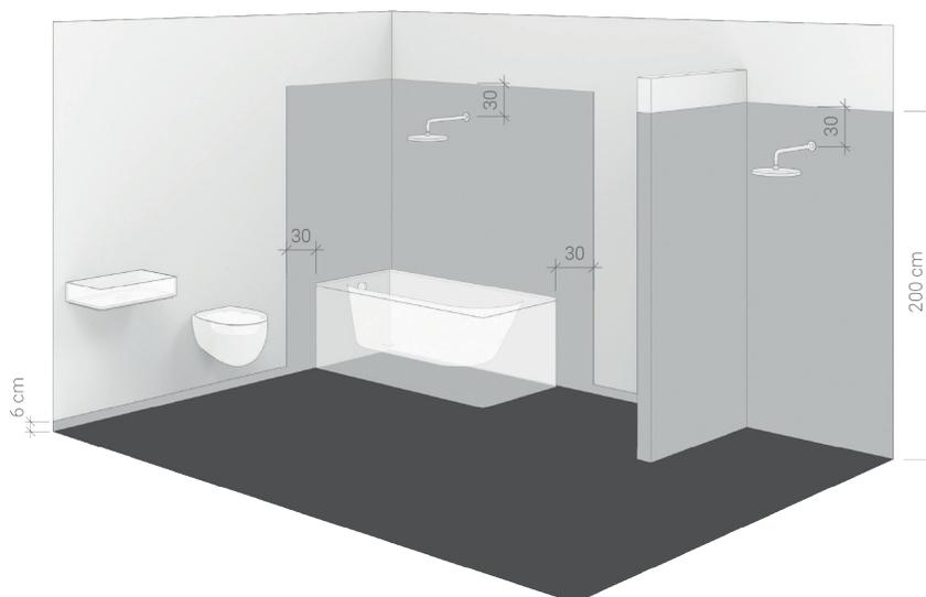
Die Wasserisolierung, die auch als wasserbeständige, feuchtigkeitsbeständige oder wasserabweisende Isolierung bezeichnet wird, schützt den Untergrund vor Wassereinwirkung. Wände müssen bis zu einer minimalen Höhe von 2,0 m abgedichtet werden. Die Wasserisolierung ist mittels Anstrich oder Dichtungsmatte möglich.
