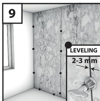
Stecken Sie nach dem Kleben des ersten Paneels die Befestigungsclips ein – damit wird eine Fuge zwischen den Paneelen (2 – 3 mm) hergestellt, welche die Nivellierung der Oberfläche einfacher macht. Nivellieren Sie die angrenzenden Flächen, wenn das nächste Paneel aufgeklebt wird. Entfernen Sie die Clips nicht bevor der Klebstoff abgebunden ist. Fahren Sie mit der Montage der nächsten Paneelen fort.
