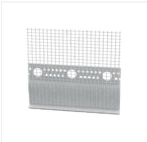
Das Blechanschlussprofil erlaubt den Anschluss von Putzflächen an aufgehenden Verblechungen, z.B. an Dachgauben, Garagen, Attika- und Sockelblechen. Die einzelnen Profiltile lassen sich wiederum mit Steckverbindern verformungssicher verbinden. Das Blechanschlussprofil wird mit leichtem Abstand auf den freien Rand des Bleches gesteckt, danach die Gewebefahne zur Fixierung mit Armierungskleber auf der Dämmplatte eingespachtelt.
