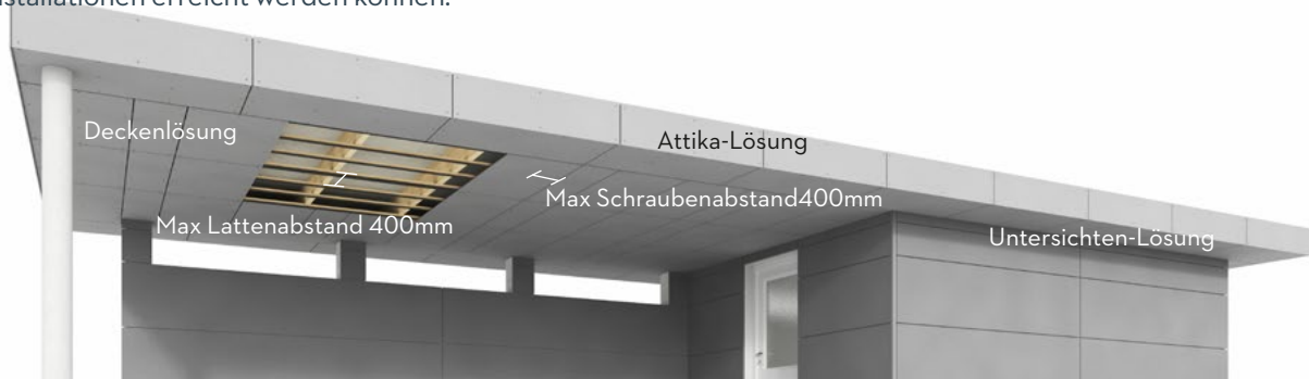
Schrauben- und Lattenabstände
