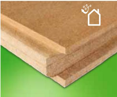
Bei Dachsanierungen von außen ist es notwendig, dass so schnell wie möglich der Witterungsschutz für die darunterliegende Wohnfläche gewährleistet wird. Die umlaufende Spezial-Profilierung von STEICOspecial garantiert die Winddichtigkeit und Wasserableitung ohne zusätzliche Fugenabklebungen bei Dachneigungen von mindestens 18°.
