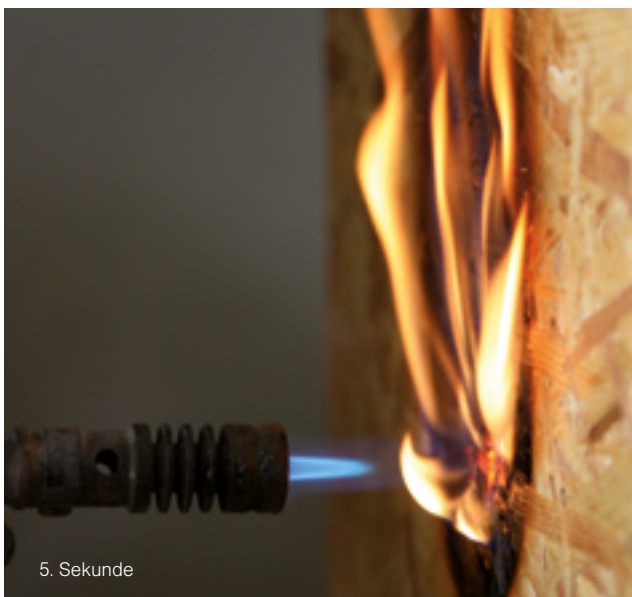
Bild Nr. 2 Durch die Verwendung von OSB Platten mit der Pyrotite® Oberflächenbehandlung kann die Zeit bis zur vollständigen Entzündung von ein paar Minuten bis auf Dutzende von Minuten ausgedehnt werden.
